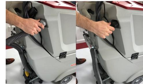
Einfacher und schneller Wechsel des jeweiligen Saugschlauchs.
