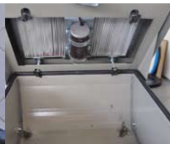
Großer, robuster Grobschmutzbehälter mit großem Filter und kräftigem Rüttler (Sweep CS 800).
