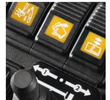
Drucktasten zum Entleeren des Behälters
