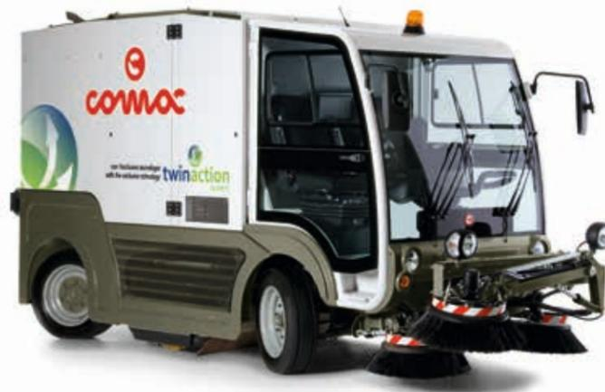
Die CS140 Twin Action besitzt einen Kehrgutbehälter mit einem Fassungsvermögen von 3,5m<sup>3</sup> und vereint in einer kompakten Maschine die Kehrleistung zweier Maschinen mit einem erstklassigem Qualitätsergebnis.
