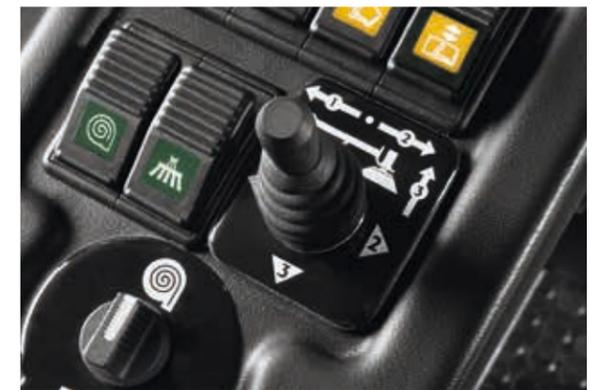
Joystick für die Steuerung der dritten Bürste.
