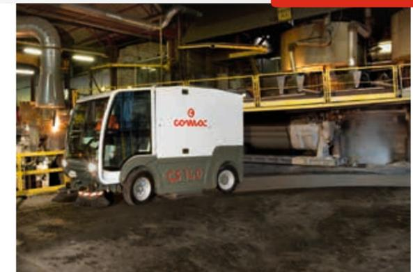
Comac hat eine spezielle Vorrichtung für die Abstandskontrolle der Maschine zum Boden entwickelt, die diesen Abstand durch getrenntes Einwirken auf alle 4 Räder konstant hält und dadurch die Arbeit und die Stabilität optimiert. Diese Vorrichtung ist auch in der Lage, die Maschinenhöhe auch bei unterschiedlicher Belastung unverändert beizubehalten. Der Bediener kann die Maschine entsprechend den jeweiligen Gegebenheiten auf 3 unterschiedlichen, vorgegebenen Stufen positionieren.
