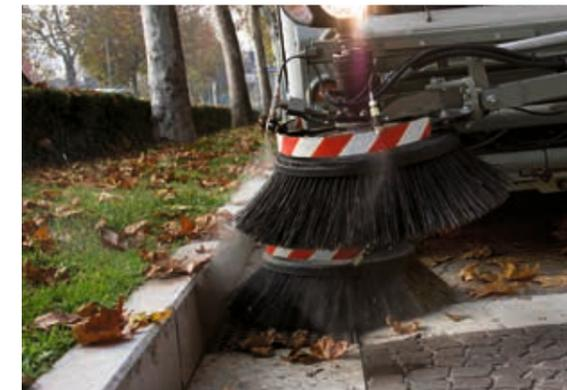
Die Seitenbürsten können mit speziellen Wasserzerstäubungsdüsen (Sonderausstattung) ausgestattet sein, die für die Staubkontrolle während des Kehrens dienen.
