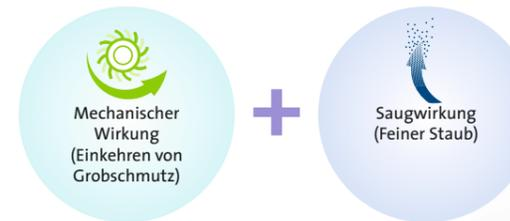
Mit dem neuen Einkehrsystem wird der Verschleiß mechanischer Maschinenkomponenten und der Wartungsaufwand drastisch reduziert. Die Förderschnecken (2) besitzen zwei hydraulisch angetriebene Stahlschnecken, die auf derselben Achse rotieren und dabei den Schmutz und Feststoffe unterschiedlichster Größen zum Saugstutzen des Ansaugrohrs befördern.
