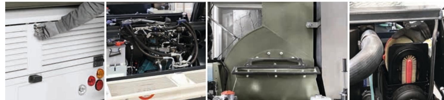
Der Motorluftfilter und der Kühler des Hydrauliköls sind im hinteren Teil der Maschine untergebracht und über eine Luke zugänglich, die sich öffnen lässt. Diese Position wurde ausgewählt, damit sie ständig einem sauberen Luftstrom ausgesetzt sind, um Verstopfungen und Überhitzungen zu vermeiden und mögliche Beschädigungen zu reduzieren.
