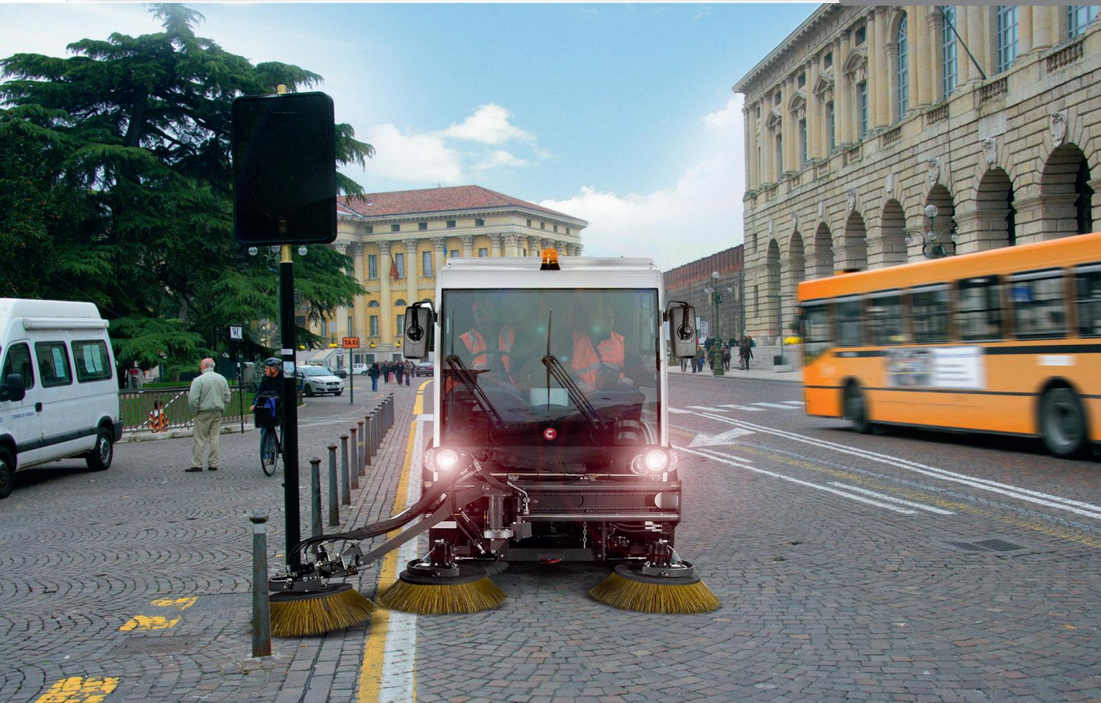
Comac hat eine spezielle Vorrichtung für die Abstandskontrolle der Maschine zum Boden entwickelt, die diesen Abstand durch getrenntes Einwirken auf alle 4 Räder konstant hält und dadurch die Arbeit und die Stabilität optimiert.
