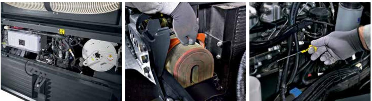
Der Motorluftfilter und der Kühler des Hydrauliköls sind im hinteren Teil der Maschine untergebracht und über eine Luke zugänglich, die sich auch bei abgesenktem Behälter öffnen lässt.
