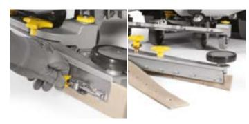
Die Gummis des Saugfußes können in wenigen Augenblicken gedreht und gewechselt Auch die außerplanmäßige Wartung Die Kehrausführung (BTS) ist mit einem werden, ohne Einsatz von Werkzeugen
