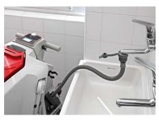
Der Schlauch zum Befüllen des Frischwassertanks lässt sich direkt an jeden Hahn anschließen, wodurch der Vorgang überall rasch durchgeführt werden kann
