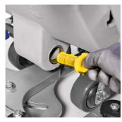
Reinigung des Frischwasserfilters
