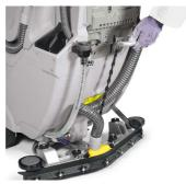
Die Kette zum Absenken des Saugfußes ist robust, aus Stahl hergestellt und verfügt über einen ergonomischen Griff aus Druckgussaluminium
