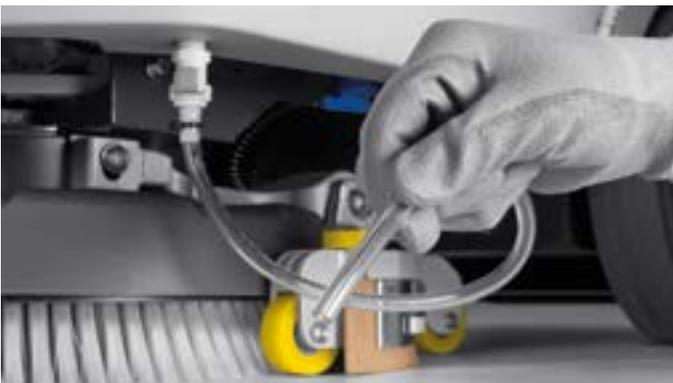
Auch das Entleeren des Reinigungsmittel tanks kann praktisch und schnell mithilfe des entsprechenden Ablaufschlauchs durchgeführt werden, der am vorderen Teil der Vispa XL eingehakt werden kann.
