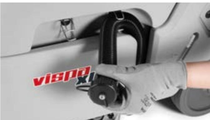
Auch die außerplanmäßige Wartung ist einfacher, da alle Komponenten vollkommen zugänglich sind. Der Schmutzwassertank ist mit einem praktischen Griff zum einfachen Anheben und Entleeren ausgestattet. Um den Vorgang noch einfacher zu gestalten, kann der Schmutzwassertank der Vispa XL auch über den Schlauch seitlich entleert werden.
