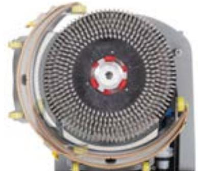
Der Saugfuß kann um 180° gedreht werden; in Seitenlage können Wartungsarbeiten und Radwechsel einfach und schnell durchgeführt werden.
