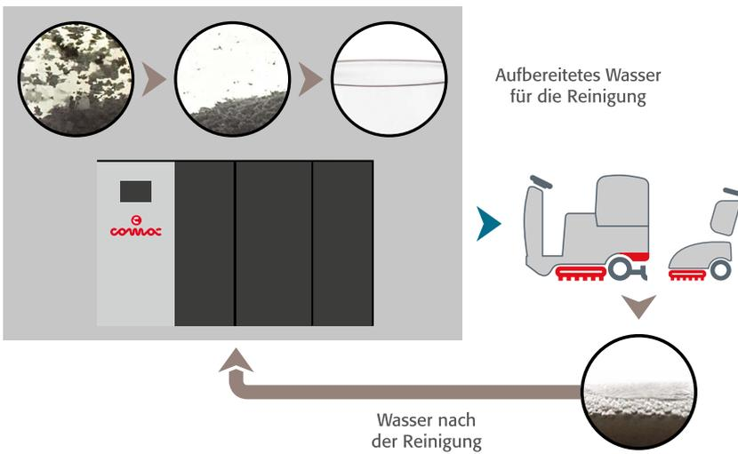
Die InAqua ist ein unabhängiges, einfach bedienbares System. Das schmutzige Wasser wird direkt in die Recyclingstation abgelassen.
