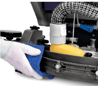
Um eine einwandfreie Trocknung zu gewährleisten, müssen der Saugschlauch und die Gummilamellen der Saugleiste am Ende eines jeden Reinigungsvorgangs gereinigt werden. Die Saugleiste kann angehoben werden, um die Gummilamellen schnell zu reinigen
