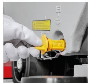
Reinigung des Lösungsfilters
