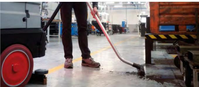
Suction Tool zum Reinigen von sehr schwer zugänglichen Bereichen mit der Saugglanze.
