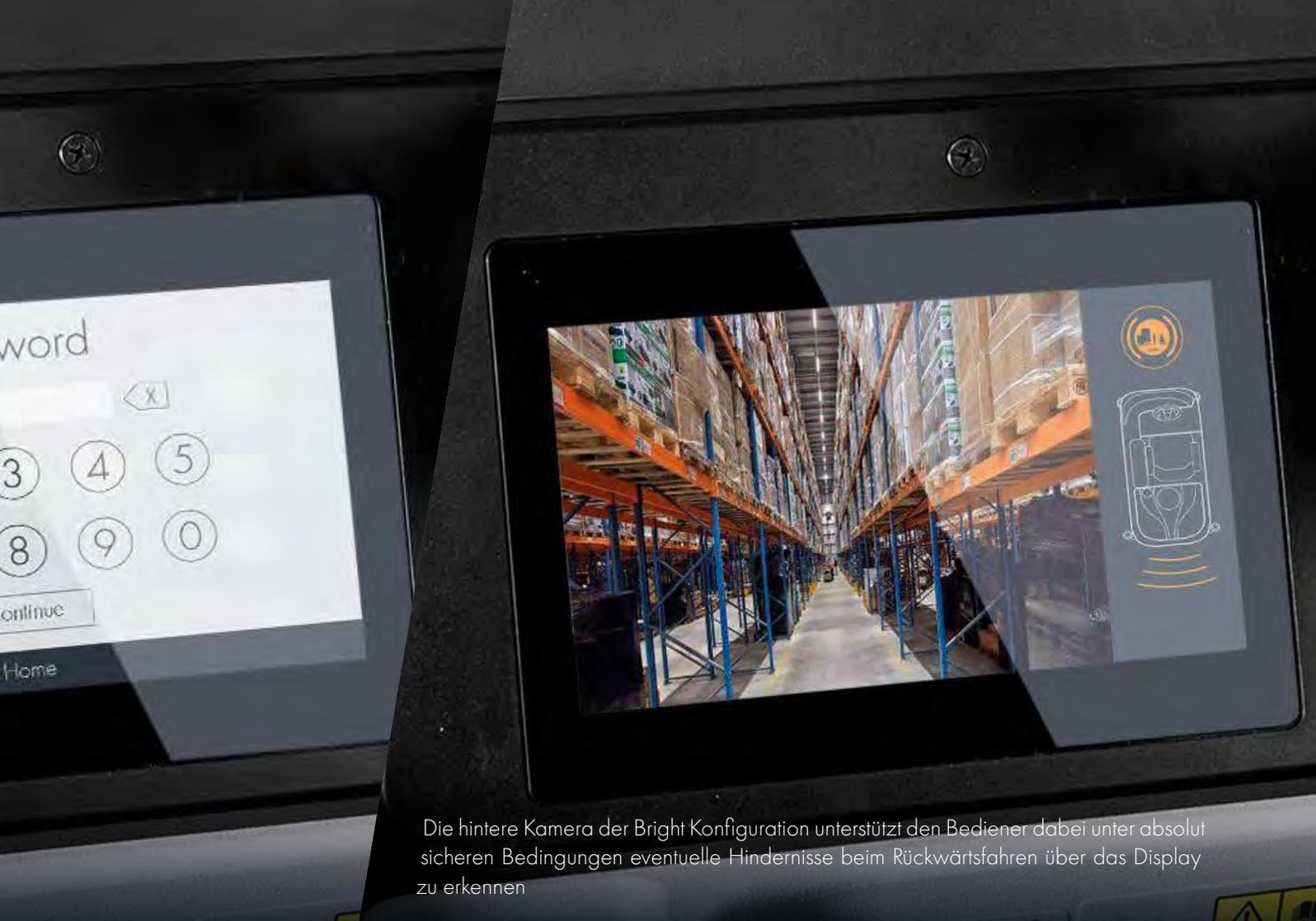
Die hintere Kamera der Bright Konfiguration unterstützt den Bediener dabei unter absolut sicheren Bedingungen eventuelle Hindernisse beim Rückwärtsfahren über das Display zu erkennen
