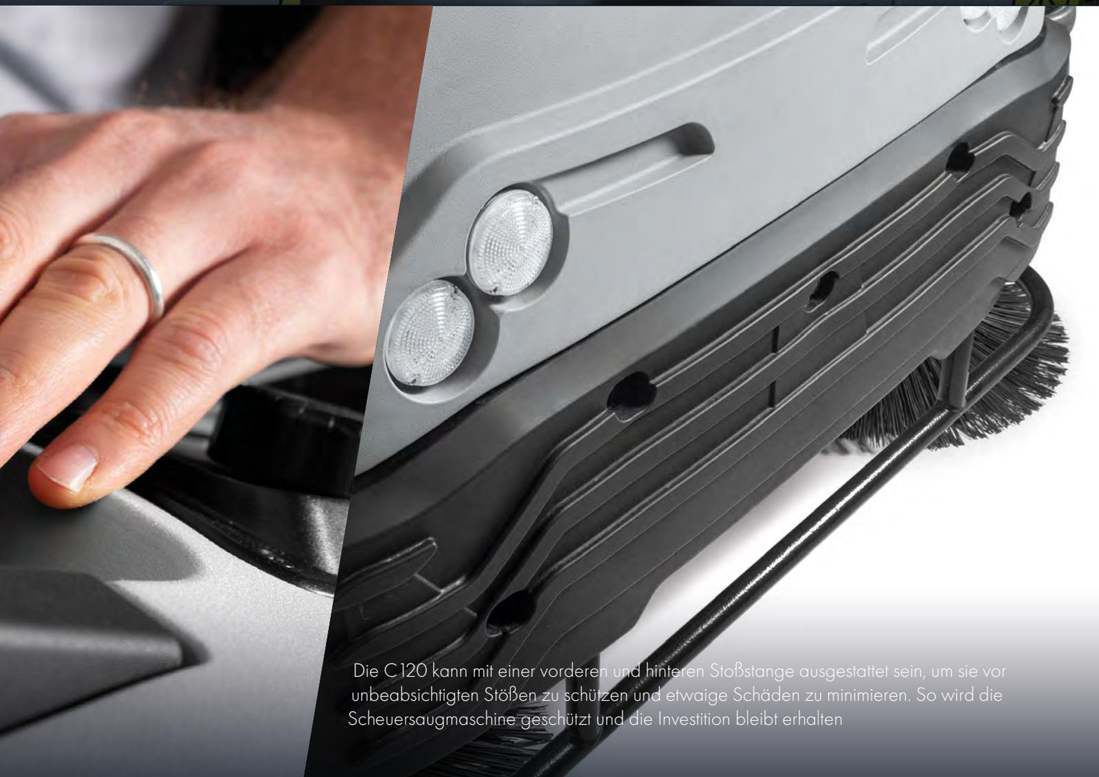
Die C120 kann mit einer vorderen und hinteren Stoßstange ausgestattet sein, um sie vor unbeabsichtigten Stößen zu schützen und etwaige Schäden zu minimieren. So wird die Scheuersaugmaschine geschützt und die Investition bleibt erhalten
