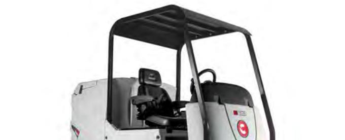
Möglichkeit zur Installation des Fahrerschutzdachs zum Schutz des Bedieners stehen könnte.
